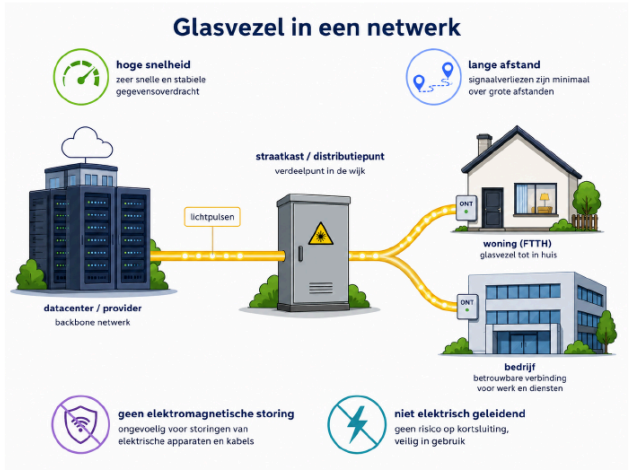
Figuur 2: Schematische illustratie van glasvezel in een netwerk
